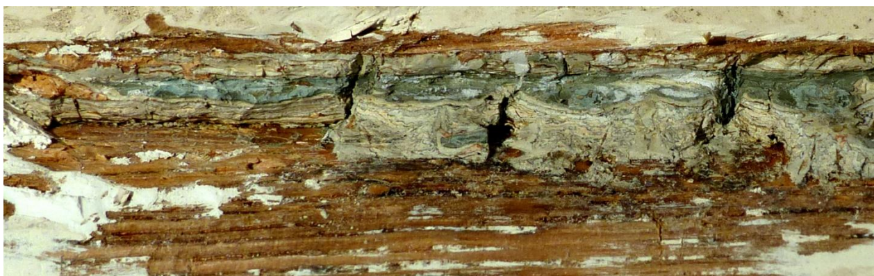
60. Fragment odkrywki nr 3 E, z zachowanymi śladami licznych nawarstwień technologicznych w zagłębieniu na styku profilu półwałka z górną belką pod tympanonem. Pod błękitną warstwą malarską rozróżnioną w odkrywce nr 2 jako ósmą, leżącą bezpośrednio na drewnie, tu w widocznym miejscu na fotografii w odkrywce nr 3 E - warstwę błękitną dzieli kilka warstw od powierzchni drewna.
